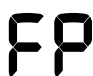
工場プリセット設定が復元されると、'FP' がターゲットID表示欄に表示されます。
